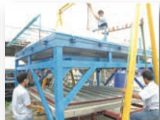
ทดสอบการรั่วซึมภายในตู้ควบคุมน้ำ และแรงดัน
